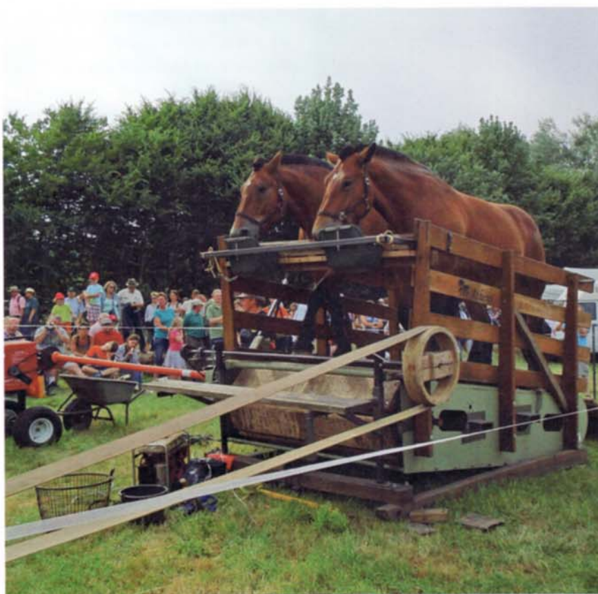
Kaltblutpferde in Aktion: durch das Laufband wurden gleichzeitig eine Säge und ein Holzspalter angetrieben.
