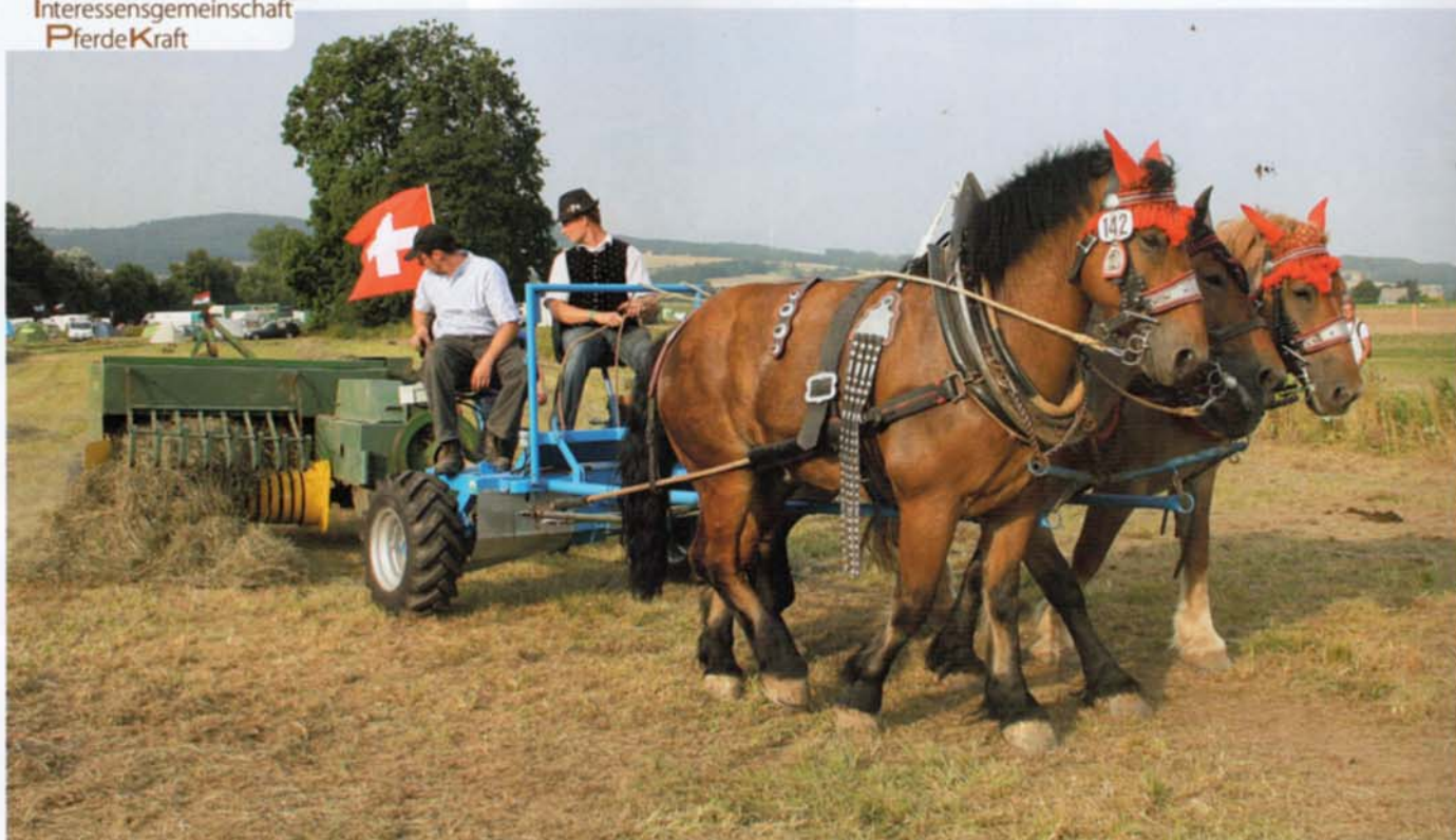
Mit einem Schweizer bodengetriebenen Vorderwagen wird dreispännig eine Hochdruckpresse angetrieben.
